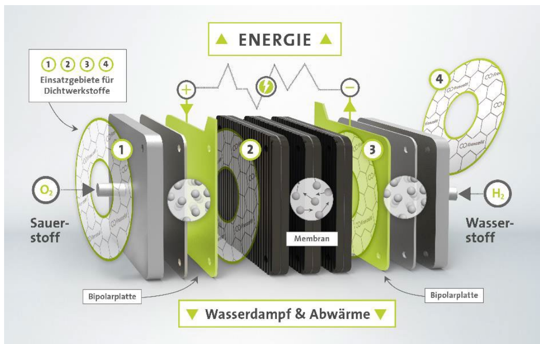
Bild 1: Die Abbildung zeigt die verschiedenen möglichen Einsatzorte für Dichtwerkstoffe in Brennstoffzellen. Dazu zählen zum einen die Abdichtungen der Wasserstoff- und Sauerstoffzuleitungen (Position 1 und 4) sowie die Abdichtung der einzelnen Stacks an den Bipolarplatten (Position 2 und 3).
