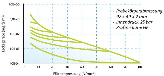
Die neue Generation novatec® PREMIUM XP zeichnet sich durch eine deutlich reduzierte Leckage bei den üblichen Flächenpressungen aus.
