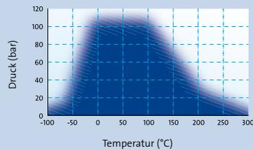
Die genannten Druck- und Temperaturgrenzen werden neben den Materialcharakteristika auch maßgeblich von den Einbaubedingungen (insbesondere der Flächenpressung) beeinflusst. Die Angaben sind daher nicht als feste Einsatzgrenze, sondern als sicherheitsorientierte Einschätzung zu verstehen.
