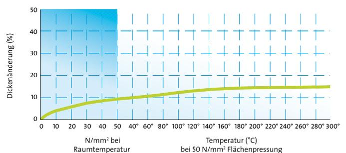
novatec® PREMIUM XP weist nur eine sehr geringe Dickenreduzierung unter Temperatur auf. Bei 300 °C liegt diese lediglich rund 5 % über dem Wert bei Raumtemperatur.
