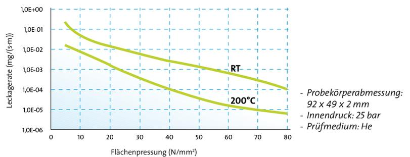
novatec® PREMIUM XP ist konzipiert für geringste Leckage. Die Mikroporosität des innovativen Dichtungsmaterials wird unter Temperatur und Flächenpressung verringert.
