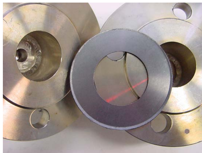
Bild 4: Die neu entwickelte Graphitdichtung zeigt auch bei höheren Temperaturen keine Anhaftung am Flansch (hier nach 24 h bei 300 °C)
