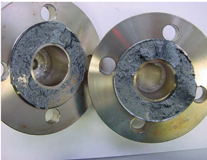
Bild 3: Typische Graphitanhaftung am Flansch nach 24 h bei 300 °C.
