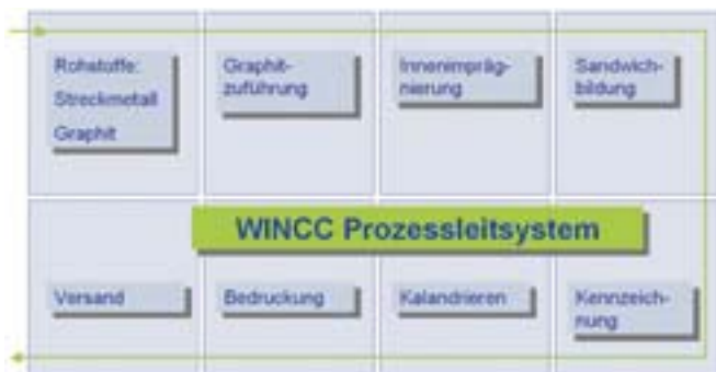
Bild 2: Schematischer Produktionsablauf unter der Steuerung und Überwachung eines Prozessleitsystems
