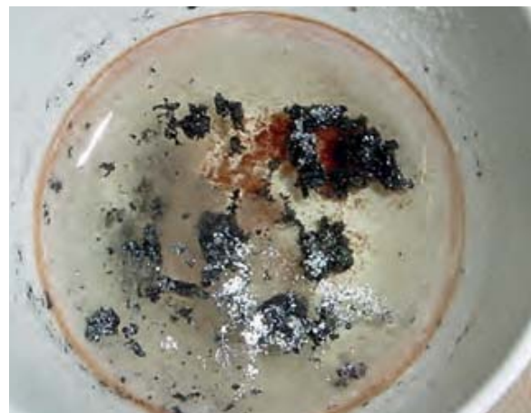
>>4: Einlagerungen nach 96 Tagen, links hochwertige Graphitfolie, rechts No-Name-Graphitfolie
