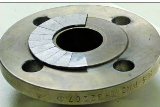
Bild 5. Verpresste und versetzt gestapelte Einzellagen aus 0,25 mm dickem Graphit der Dichte 1,0 g/cm 3 .
