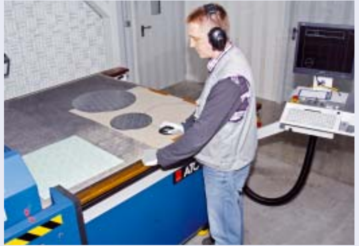
Exakter Zuschnitt: Der Dichtungsplotter verarbeitet CAD-Daten zu Dichtungen nach Maß
