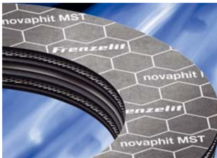
Eine Novaphit-MST-Dichtung der Dicke 3,0 mm ist in insgesamt 11 Lagen aufgebaut
