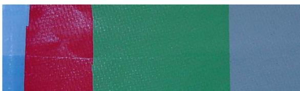
Die hohe mechanische Festigkeit wird durch das kreuzweise Laminieren der Einzellagen erreicht.
