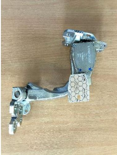
Bild 3: Hinter dem beschrifteten Blechdeckel steckt ein Trennungsmechanismus, über den z. B. bei einem Unfall das Türscharnier per Knopfdruck abgetrennt werden kann. Frenzelit steuerte hier eine Sonderentwicklung bei: eine Dichtung zur Abschirmung des Blechdeckels mit einer extra umlaufenden Dichtlippe, die aufgrund ihres Volumens kleinste Hohlräume ausgleichen kann. *Bild: © Innomotive Systems Hainichen GmbH*
