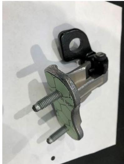
Bild 1 und 2: novaform®-Dichtungen, aufgesteckt auf die Seitentürscharniere. Gut zu erkennen sind die sternförmig ausgestanzten Löcher, die ein Verrutschen der Dichtungen z. B. beim Transport verhindern. *Bild: © Innomotive Systems Hainichen GmbH*
