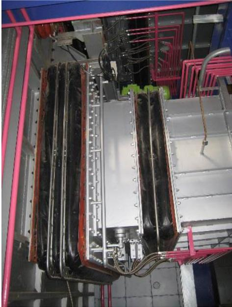
In der Schnellkühlstrecke der Anlage muss ein deutlich höherer Wasserstoffanteil innerhalb der Schutzatmosphäre abgedichtet werden; hierzu kommen Doppelkompensatoren mit innerem und äußerem Gewebekompensator zum Einsatz. *Bild: ©Frenzelit GmbH*
