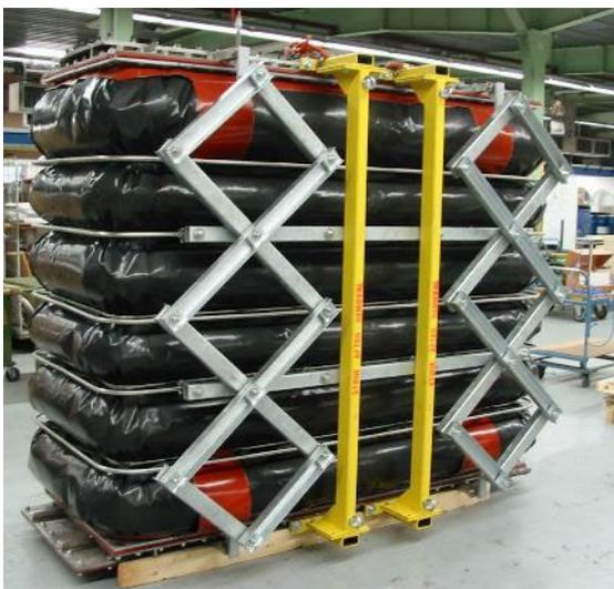
Snout Bellows sind komplexe Gewebekompensatoren, die aus bis zu zwölf Gewebelagen bestehen, darunter Gewebeisolerlagen und bestimmte Dichtlagen. Durch spezielle Fügeverfahren sorgt Frenzelit für die nötige Dichtheit der Kompensatoren. *Bild: ©Frenzelit GmbH*
