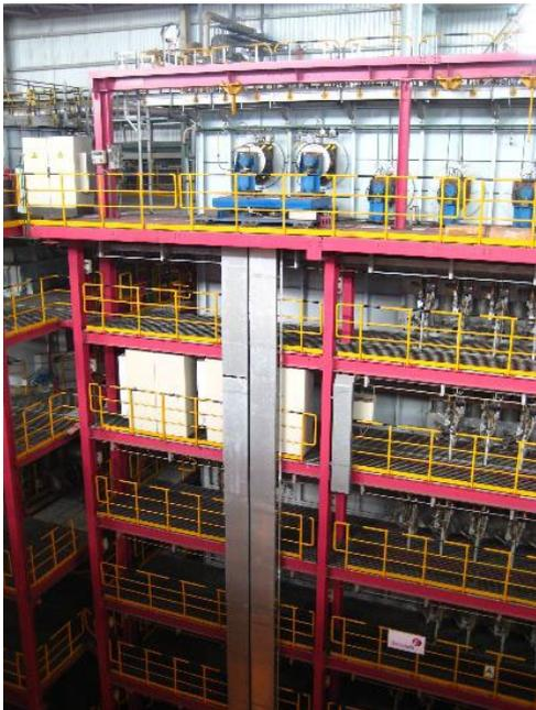
Teilansicht eines Vertikalofens in einer Kontiglhe mit Steuerrollen-Kompensatoren im oberen Bereich. *Bild:* ©Frenzelit GmbH
