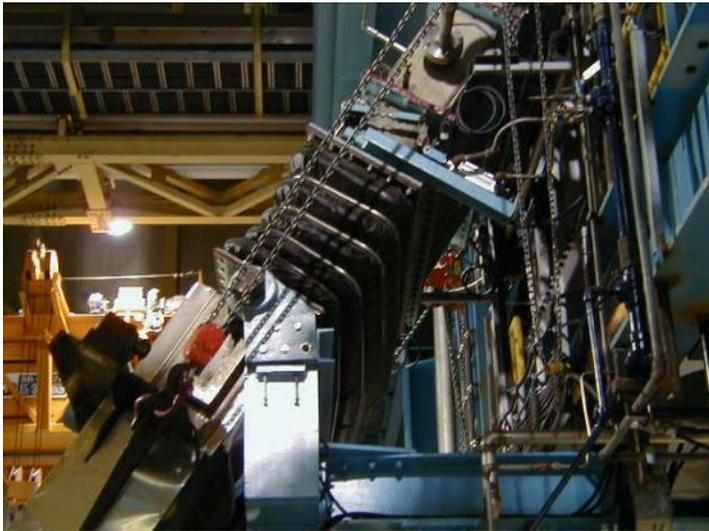
Snout Bellows werden ausschließlich in Bandverzinkungsanlagen eingesetzt, um die Düse, die die Bleche ins Zinkbad eintaucht, vor- und zurückzuziehen. *Bild: ©Frenzelit GmbH*
