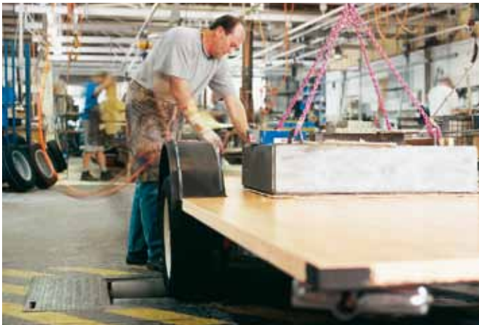
Basisarbeit: HICOTEC® TP-Heizfolie unter dem PVC-Bodenbelag auf der Chassis-Platte.
