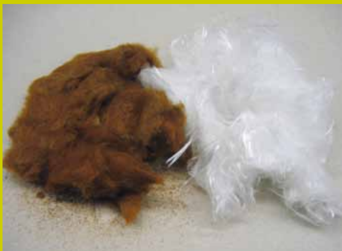
Basalt und Glas im Direktvergleich: Nach sechs Monaten in der Praxis haben die Glasfasern (rechts) ihre Struktur erhalten.
